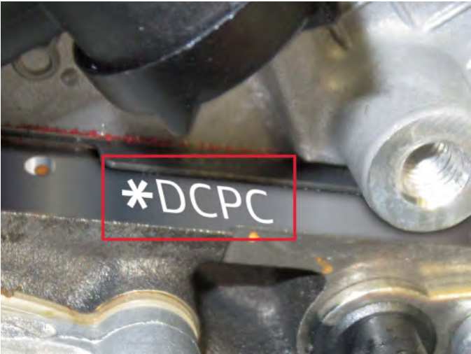
Буквенное обозначение двигателя выбито на блоке цилиндров, рядом с датчиком температуры системы терморегулирования двигателя G694.
