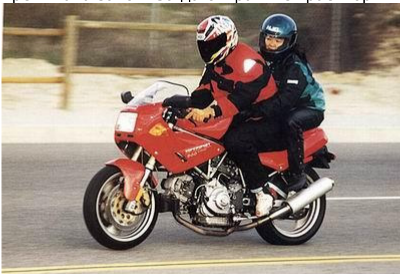
При ускорение с пасажер предното колело се разтоварва, което затруднява завиването.
