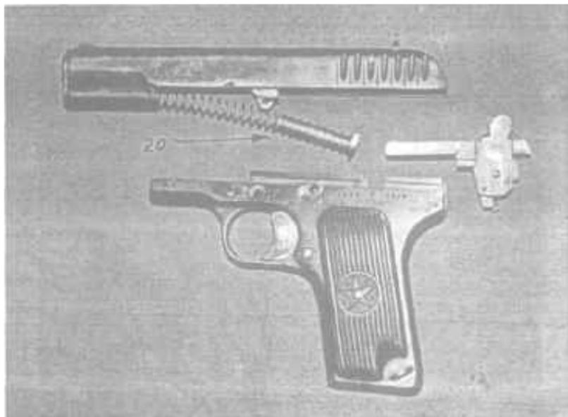
Фото 13. Разборка пистолета. Извлечь возвратную пружину 20
