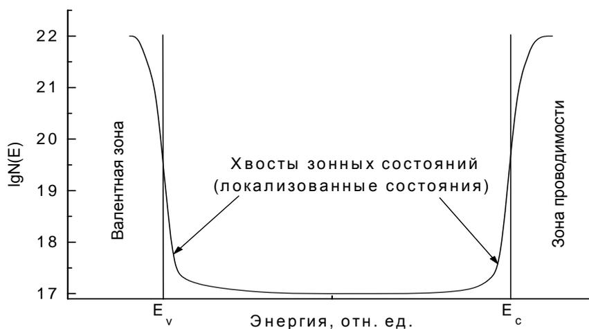
Рис. 2.40. Зонная схема стекла.
