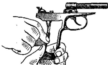
Рис. 23. Закрепление боевой пружины задвижкой
