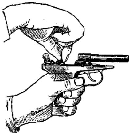
Рис. 24. Присоединение затворной задержки и шептала к рамке
