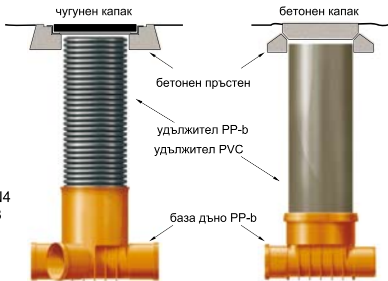
Схема на шахта с удължител PRAGMA, бетонен пръстен и чугунен капак
