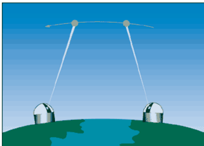
Фиг. 1.1. Лазерни измервания до спътници
