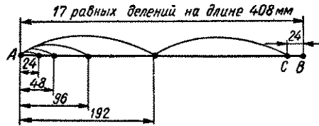
Рис. 33. Деление отрезка на 17 частей.
