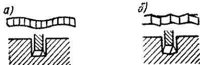
Рис. 35. Разведенные зубья ножовочного полотна:
