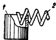
Рис. 65. Положение конца пружины в трубке при нагреве перед обжатием.
