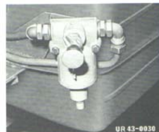
Fig. 92 Filtre avec prise de gonflage de pneus 404.1
