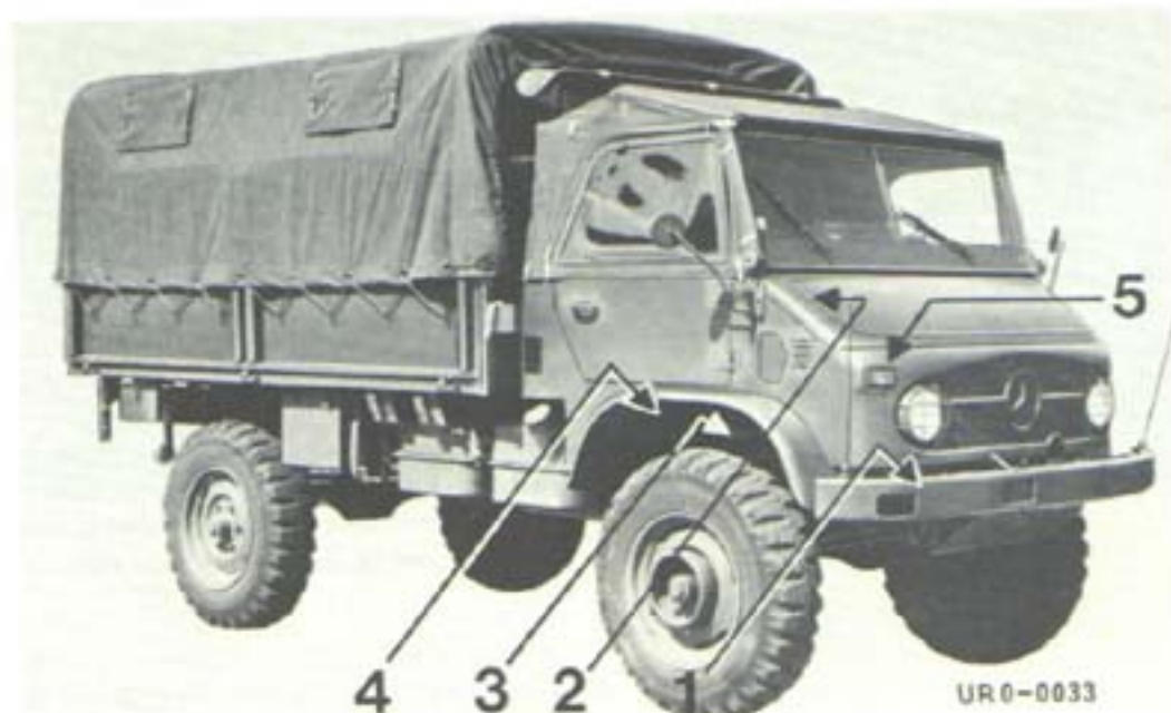
Fig.2 Emplacement de la plaque constructeur et des numéros, type 404.1
