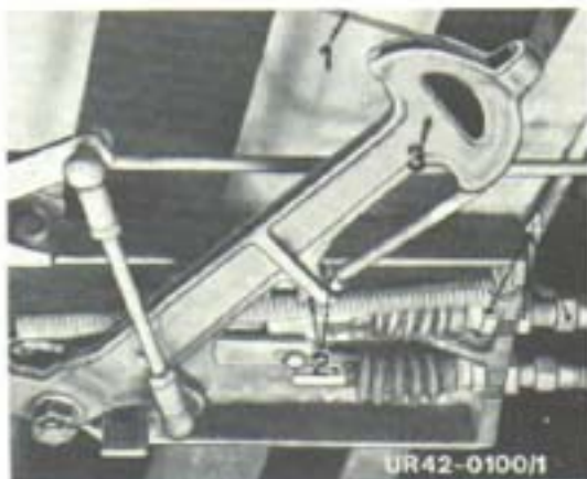
Fig. 85 Réglage du frein de stationnement
