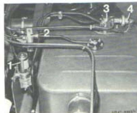
Fig. 57 Pompe additionnelle à carburant. Version II sur type 404.1
