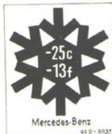
Fig. 31 Véhicule avec antigel assurant une protection jusqu'à -25° C ou -13° F
