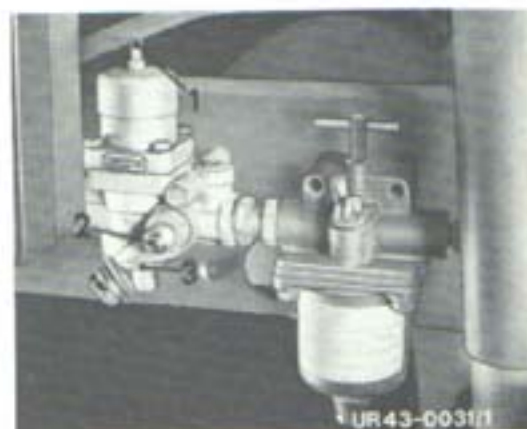
Fig. 91 Régulateur de pression et appareil antigel
