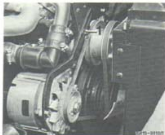
Fig. 63 Tension de la courroie trapézoïdale
