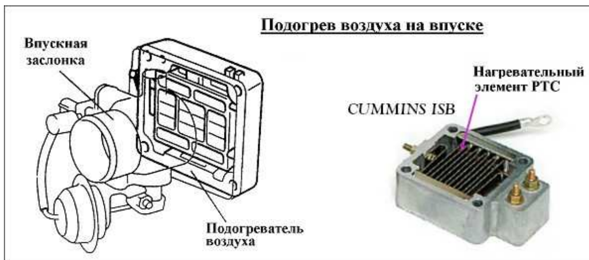
Рис. 3.46. Подогреватель воздуха на впуске.
