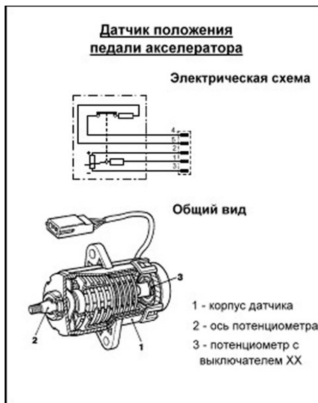
Рис. 6.15. Принципиальная схема датчика положения педали акселератора.
