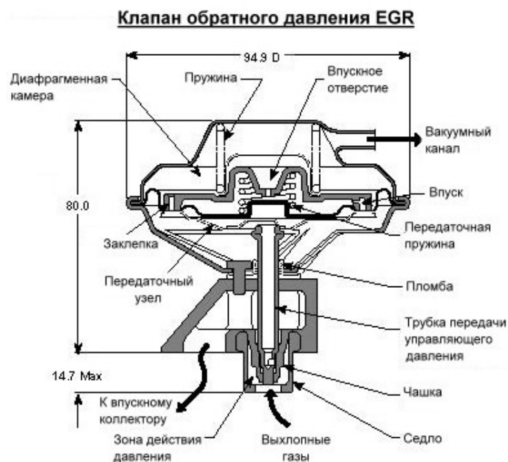
Рис. 3.10. Устройство клапана EGR.
