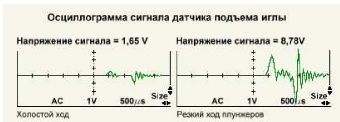
Рис. 6.25. Осциллограмма сигнала датчика подъема иглы форсунки.
