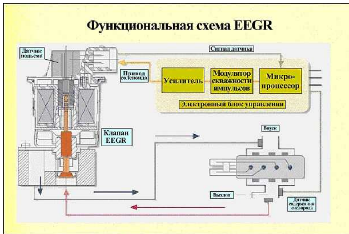
Рис. 3.15. Функциональная схема электронной системы EGR.
