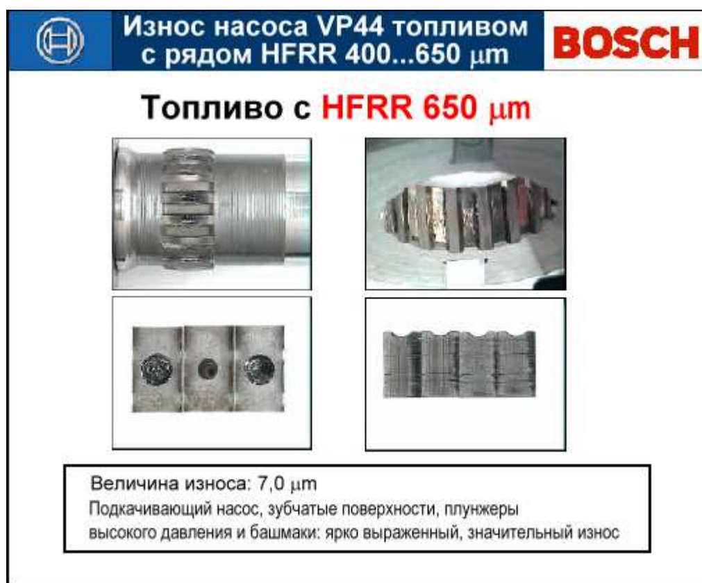
Рис. 6.2. Износ деталей топливом с низкими смазочными свойствами.
