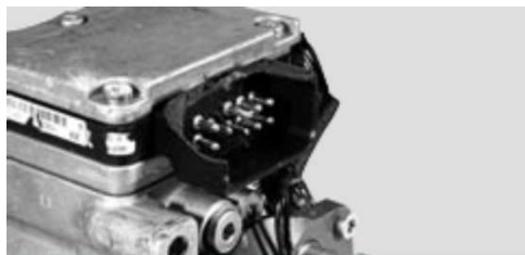
Разрушение разъема EDU
