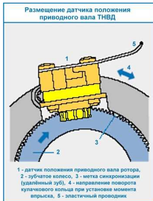
Рис. 2.12. Расположение датчика положения ротора в ТНВД.
