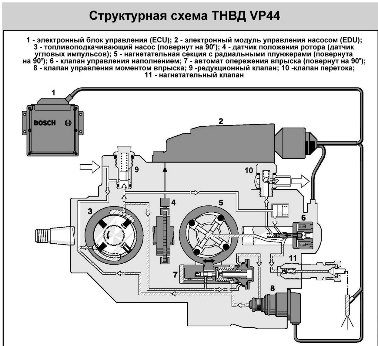
Рис. 2.3. Структурная схема ТНВД VP44.
