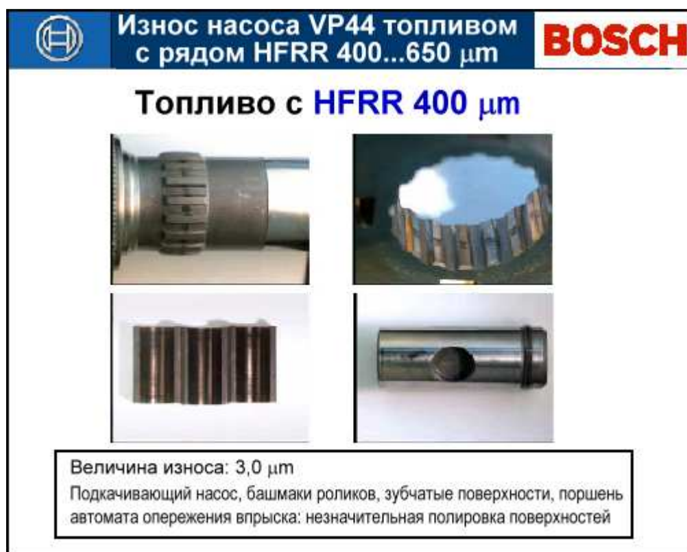
Рис. 6.3. Износ деталей топливом с высокими смазочными свойствами.
