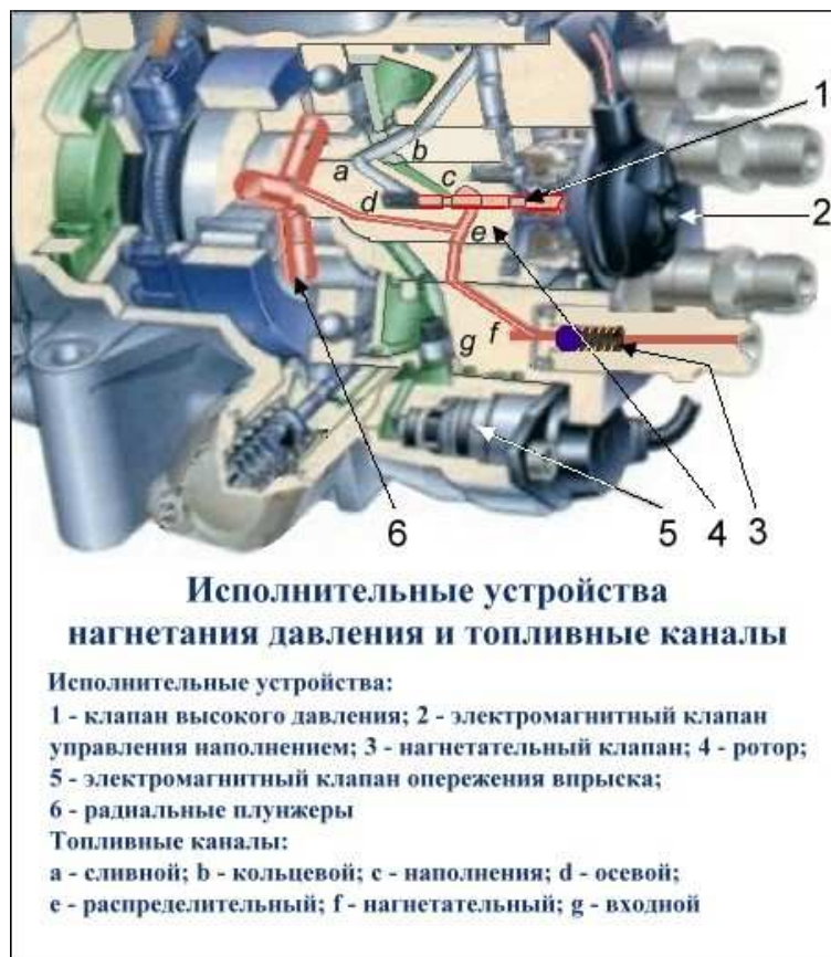
Рис. 2.24. Топливные каналы и устройства нагнетания давления.
