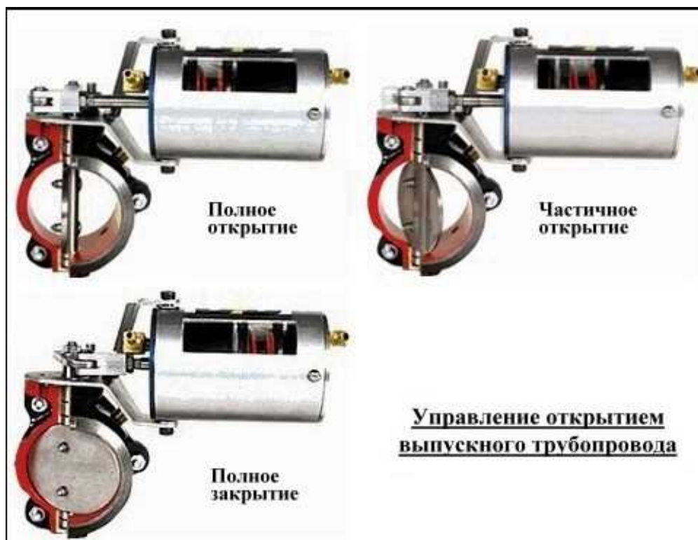
Рис. 3.25. Рабочие положения заслонки стандартного устройства торможения выхлопом.
