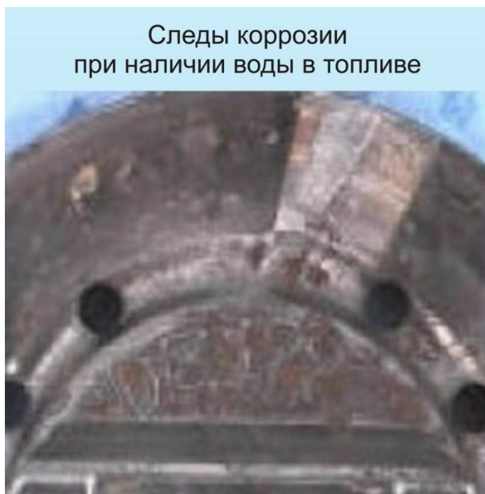
Рис. 6.4. Следы коррозии на детали ТНВД.
