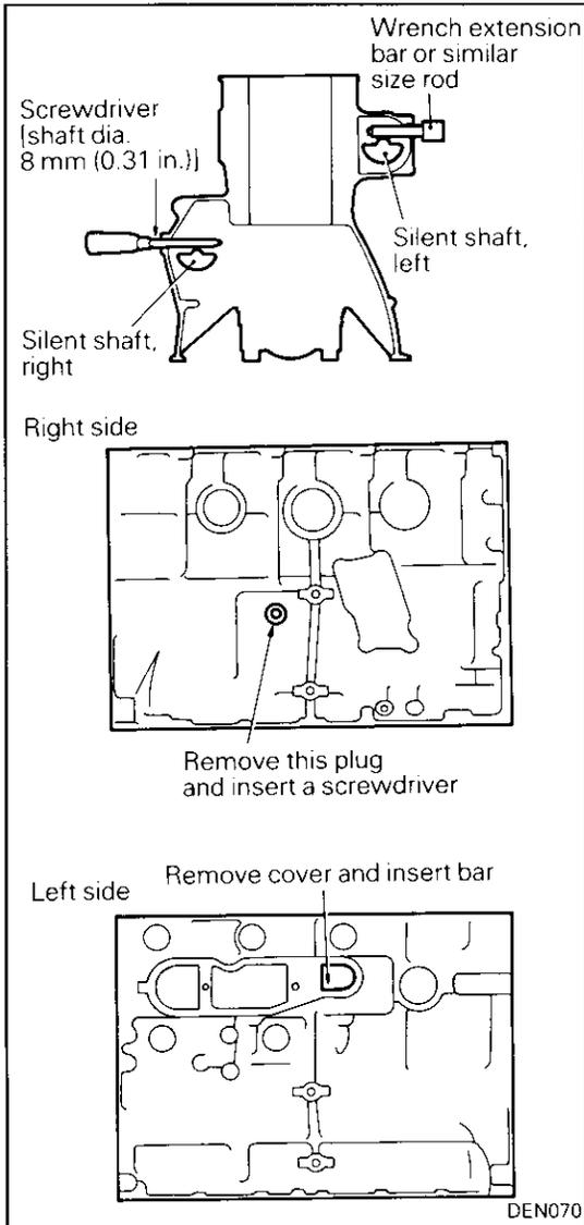
**REMOVAL OF SILENT SHAFT SPROCKET RIGHT / LEFT**
