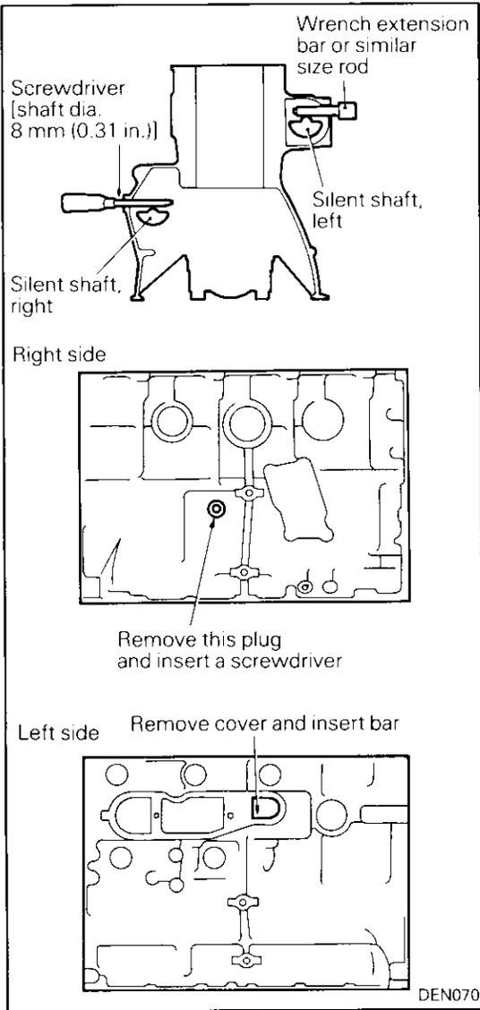
**◆C◆ INSTALLATION OF SILENT SHAFT SPROCKET, RIGHT / SILENT SHAFT SPROCKET, LEFT**
