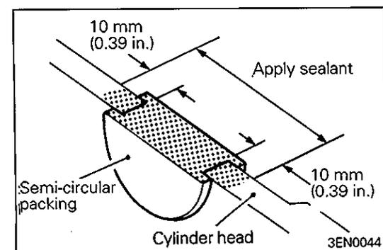
**◆D◆ INSTALLATION OF ROCKER SHAFT**
