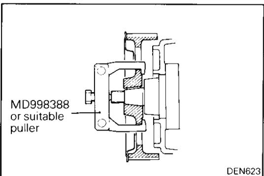
**◊B◊ REMOVAL OF INJECTION PUMP SPROCKET**
