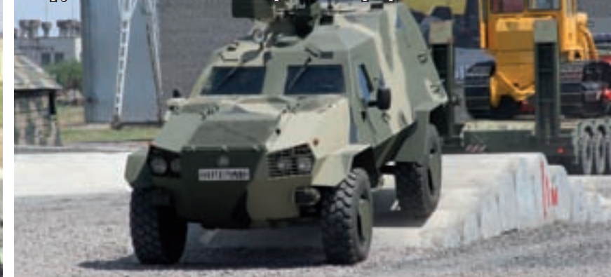
Отечественный бронетранспортер БТР-3Е1 при прохождении испытательного препятствия "Ров"
