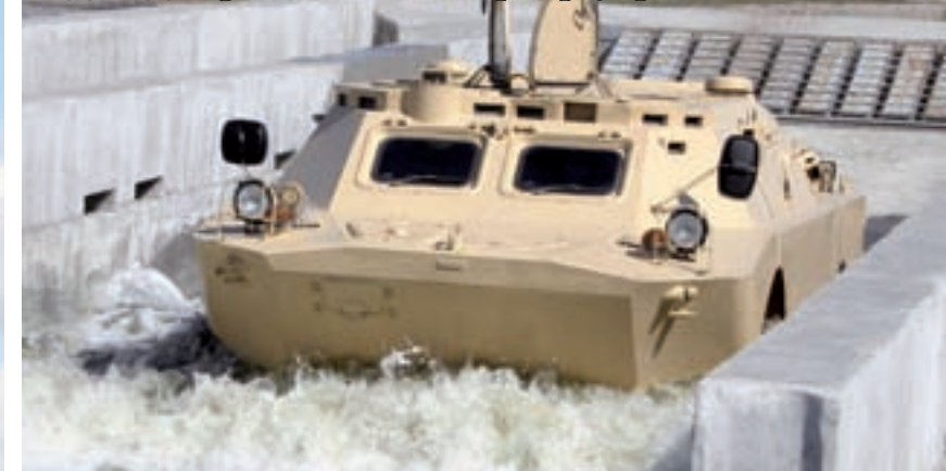
Броневедомитель "Дозор Б" преодолевает испытательное сооружение "Холм волнообразного профиля"
