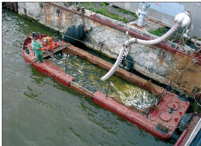
Рис. 268. Разгрузка рыбонасосом прорези (с тихоокеанскими лососями и другими рыбами), доставленной катером со ставного морского невода – ООО «Роял Стэйт» (19 июля 2006 г.)
