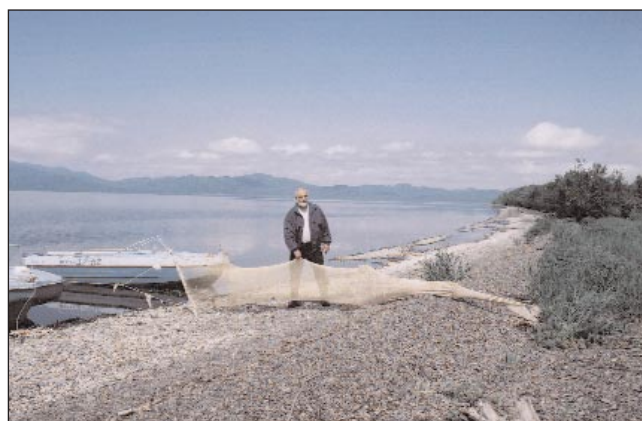
Рис. 67. Общий вид малькового близнецового трала – именно это орудие лова обеспечило 25-летние сборы молоди нерки в бассейне оз. Азабачьего (июль 2005 г.)
